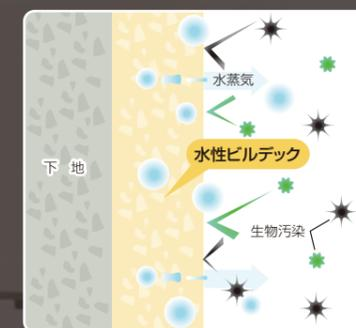
基材内部の水分を水蒸気の形で外部へ
