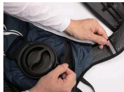
④ケーブルをベストから外す ⑤モーターからホースを抜く (2本)
