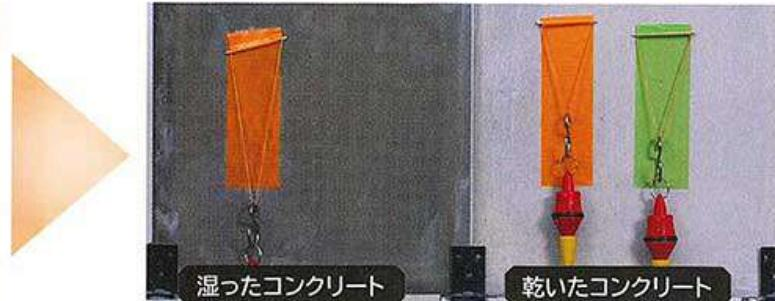
湿ったコンクリートと乾いたコンクリートに本製品と一般的な養生テープを貼付け、おもりで負荷をかけた実験を実施。本製品は湿ったコンクリートにも乾いたコンクリートと同様の貼付け強度を発揮した。
