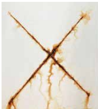
当社弱溶剤変性エポキシ樹脂 下塗り塗料 (60 \mu m \times 2回)
